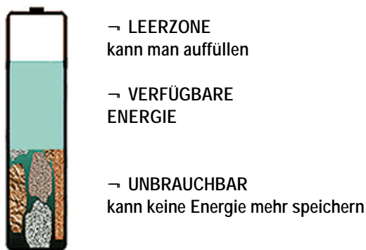
Bild 1: Die drei imaginären Abschnitte eines Akkus bestehen aus verfügbarer Energie, der Leerzone, und dem unbrauchbaren Bereich. Durch Gebrauch und Alterung vergrößert sich der unbrauchbare Bereich.
