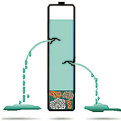
Bild 6: Akku mit hoher Selbstentladung.
