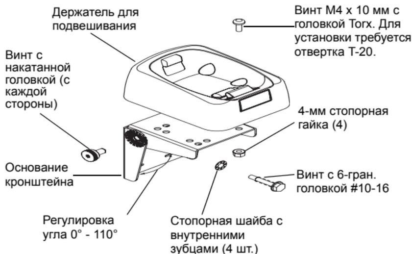
Рис. 1. Кронштейн с регулируемым углом наклона
